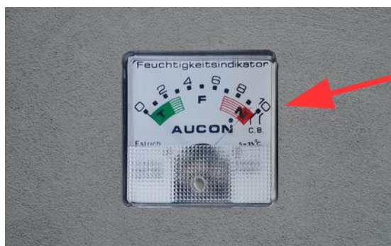
Test realizzato con igrometro su parete senza Climapron Strong
