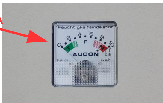
Test realizzato con igrometro su parete con Climapron Strong
